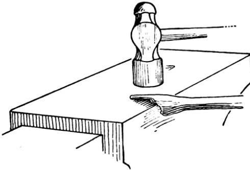
*Fig. 23. Hammering the Steps*
