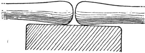
*Fig. 38. Butt Welding*
